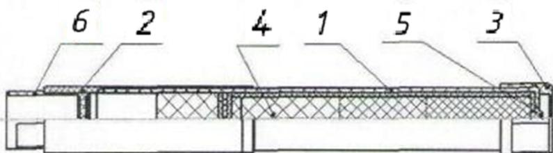
Принцип работы генератора основан на генерировании специального огнетушащего вещества (огнетушащего аэрозоля), получаемого в результате сгорания аэрозолеобразующего состава, размещенного внутри корпуса. Струя огнетушащего аэрозоля, выходящего из изделия, представляет собой белый дым. Выход аэрозоля осуществляется по оси изделия со стороны, направленной на очаг пожара с подветренной стороны.
