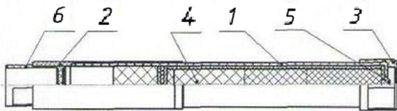
Принцип работы генератора основан на генерировании специального огнетушащего вещества (огнетушащего аэрозоля), получаемого в результате сгорания аэрозолеобразующего состава, размещенного внутри корпуса. Струя огнетушащего аэрозоля, выходящего из изделия, представляет собой белый дым. Выход аэрозоля осуществляется по оси изделия со стороны, направленной на очаг пожара с подветренной стороны.
